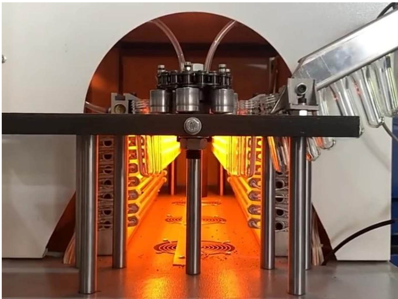
UV Resina e IR Indurimento mediante riscaldamento
