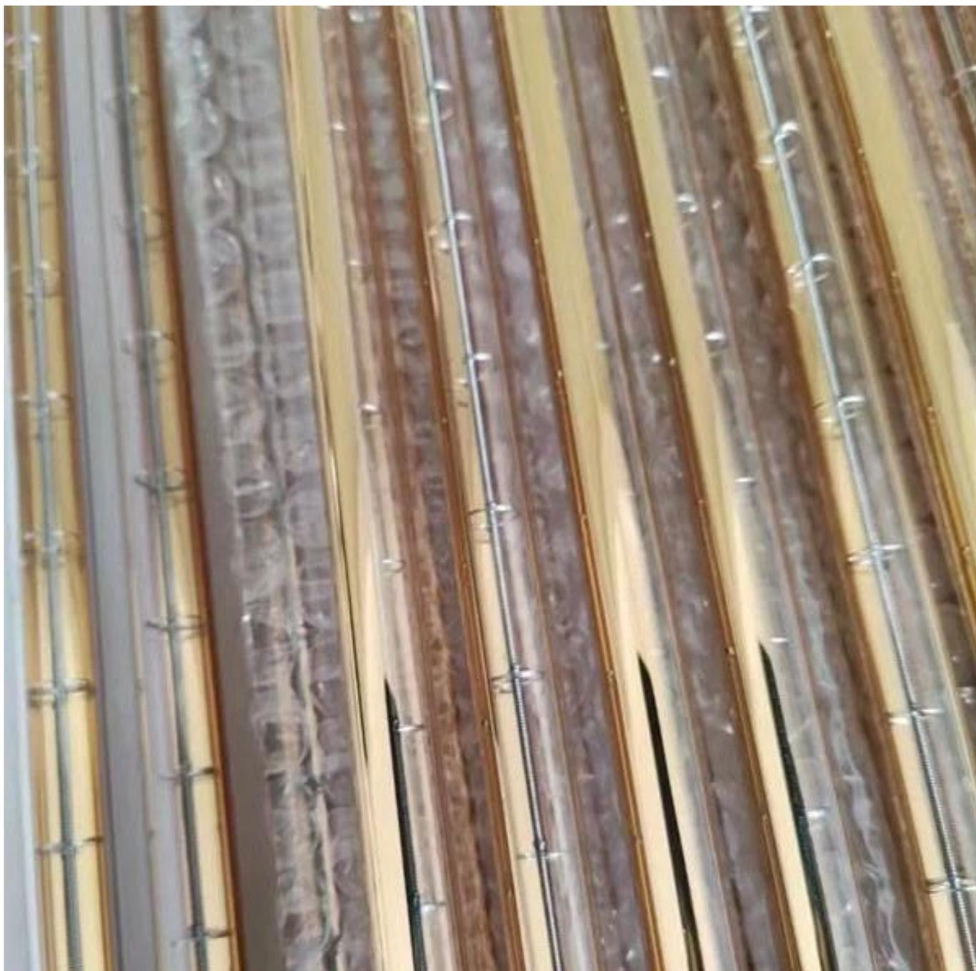
L'infrarouge à ondes courtes (proche infrarouge) présente les caractéristiques d'un temps de chauffage et de refroidissement de 1 à 3 secondes, ce qui rend le contrôle du processus de chauffage plus flexible.
