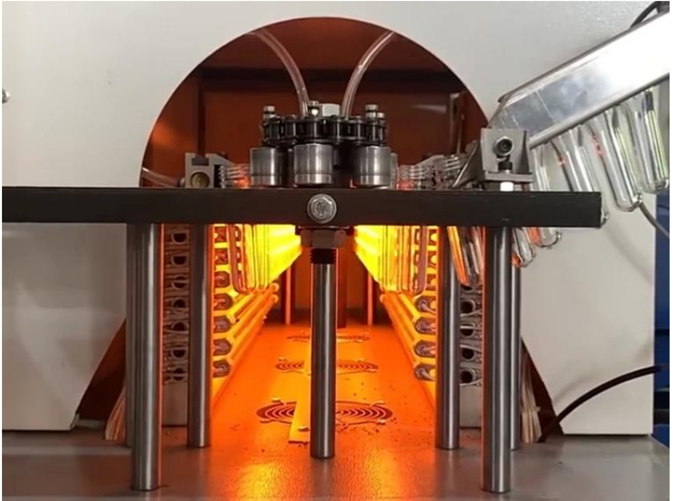
UV Harz und IR Aushärtung durch Erhitzen
